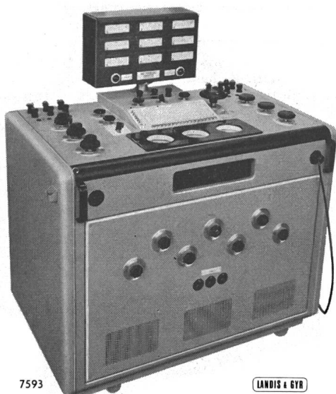
Fig. 3 Eichstation «Metrabloc» für Elektrizitätszähler
