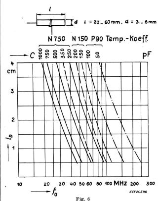
Zusammenhang zwischen der Kapazität C, der Länge der Anschlussdrähte pro Seite lD und der Resonanzfrequenz  $f_0$  von keramischen Rohrkondensatoren für eine Betriebsspannung von 500  $V_-$
