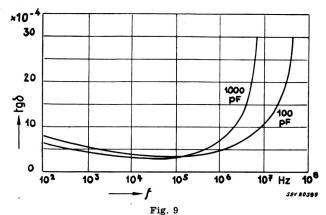
Anderung des Tangens des Verlustwinkels  $\delta$  von Glimmer-kondensatoren in Funktion der Frequenz f
