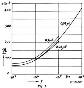
Der Tangens des Verlustwinkels  $\delta$  von mit Wachs imprägnierten zylindrischen Papierkondensatoren in Funktion der Frequenz f
