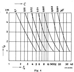
Zusammenhang zwischen der Kapazität C, der Länge der Anschlussdrähte pro Seite lD und der Resonanzfrequenz  $f_0$  von sog. selbstinduktionsfreien, zylindrischen Papierkondensatoren für eine Betriebsspannung von 400  $V_-$
