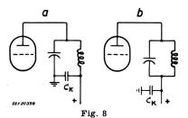
Schaltung eines Entkopplungskondensators  $C_K$  im Schwingkreis eines Verstärkers a falsch:  $C_K$  im Schwingkreis; b richtig:  $C_K$  nicht im Schwingkreis
