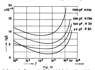
Anderung des Tangens des Verlustwinkels  $\delta$  von keramischen Rohrkondensatoren Temperaturkoeffizienten  $-750\cdot10^{-6}$ ,  $-30\cdot10^{-6}$  und  $+90\cdot10^{-6}$
