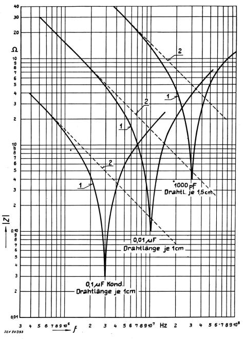
Die Resonanzfrequenz der Kondensatoren wird neben der Kapazität von der Induktivität bestimmt. Diese ist die Summe der Induktivitäten der Zuleitungen und Beläge. Die Induktivität der Beläge hängt vom Aufbau und von der Gestalt des Kondensators ab. Für die zylindrischen Papier- und Keramikkondensatoren ist sie ungefähr gleich der Induktivität eines Rohres mit den äusseren Abmessungen des Kondensators:
