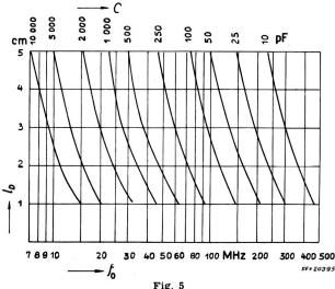
Zusammenhang zwischen der Kapazität C, der Länge der Anschlussdrähte pro Seite  $l_D$  und der Resonanzfrequenz  $f_0$  von Glimmerkondensatoren für eine Betriebsspannung von 500  $V_{\perp}$
