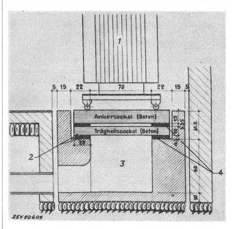
Fig. 3 Auflager der Transformatoren
