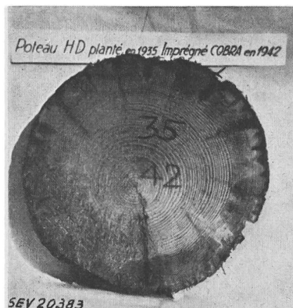
Fig. 7 Querschnitt durch einen im Jahre 1935 gestellten und 1942 nach dem Impfstichverfahren nachbehandelten Mast. Reagenzprobe mit Alizarin-Zirkonium
