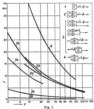
Eigenfrequenzen (f) in Funktion der Betriebsspannung (U), berechnet für verschiedene Netzkonfigurationen
