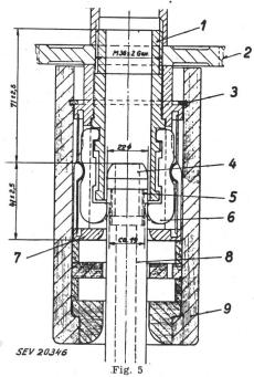
Kontaktvorrichtung für ölarme Schalter Typ V
