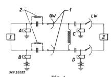
Fig. 1 Schwundbekämpfung mittels Gleichstromüberlagerung Erklärungen siehe im Text
