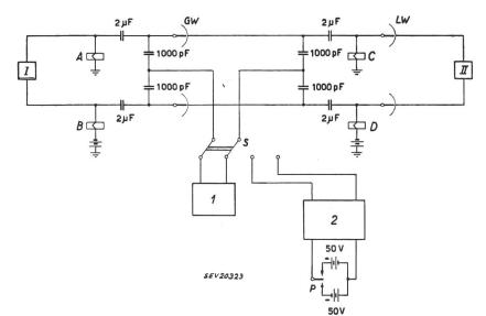
Fig. 2 Schaltschema der HF-Frittung
