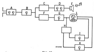
Fig. 10 Blockschema eines Fernseh-Empfängers
