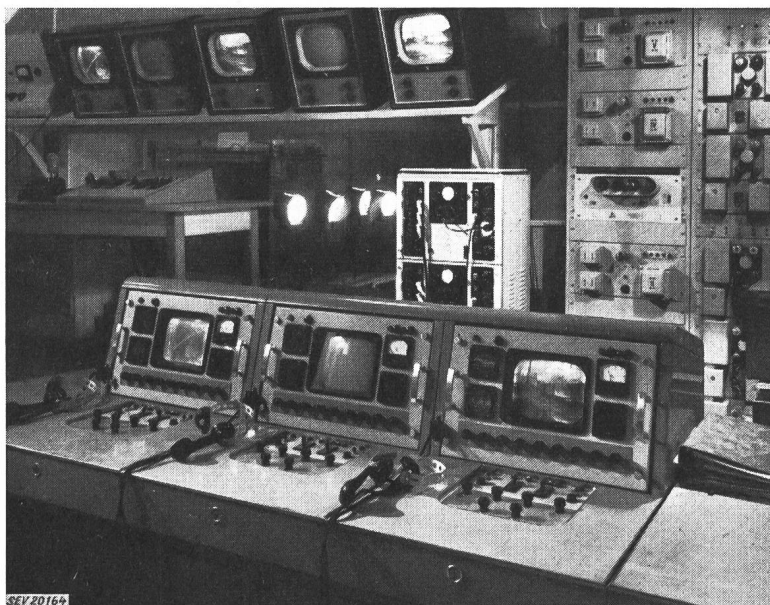
Fig. 6 Kamerakontrollpult für zwei Kameras im Studio und eine Filmkamera
