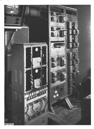
Fig. 7 Impulsgenerator (im Vordergrund) und Hochfrequenz-Telephonrundspruch-Apparatur für die Ton-Übertragung (im Hintergrund)
