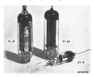
Fig. 12 Einige typische Fernseh-Empfängerröhren in Miniaturausführung
