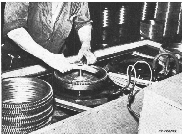
Fig. 19 Arbeitstisch für Aufschrupfen und Härten des Zahnkranzes
