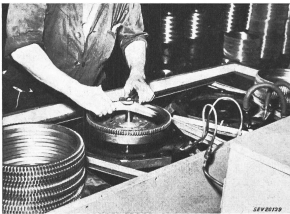
Fig. 19 Arbeitstisch für Aufschrauben und Härten des Zahnkranzes
