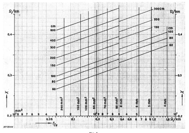
Ohmsche und induktive Widerstände von Freileitungen Ohmscher Widerstand von Cu-Leitern bei verschiedenen Querschnitten in  $\Omega/km$  induktiver Widerstand bei verschiedenen Leiterdurchmessern und Abständen in  $\Omega/km$
