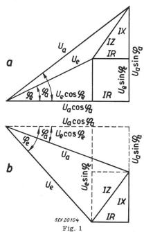
Spannungsdiagramm der Wechselstromleitung a Induktive Belastung; b kapazitive Belastung  $U_a$  Anfangsspannung;  $U_e$  Endspannung;  $U_R = IR$  Ohmscher Spannungsabfall;  $U_X = IX$  induktiver Spannungsabfall;  $\phi_a$ ,  $\phi_e$  Phasenwinkel am Anfang und am Ende der Leitung
