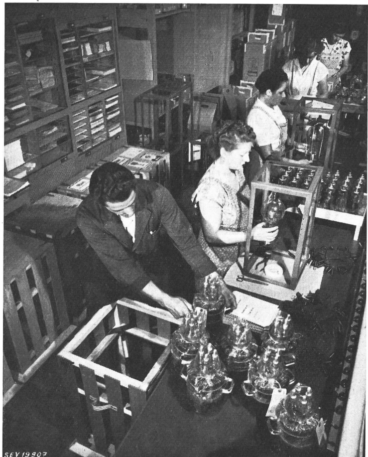
Fig. 6 Verpacken von Senderöhren Vor dem Versand werden die Röhren in mit Federn versehenen Käfigen eingespannt, um Transportschäden weitmöglichst auszuschliessen
