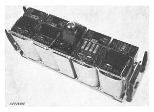
Fig. 3 Kanalplatte zu einer Trägerfrequenzanlage Hasler
