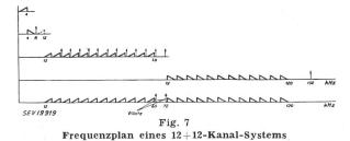
zugehörige Schaltschema. In der einen Übertragungsrichtung wird demnach mit der Basisgruppe A, in der andern mit der sog. Y-Gruppe gearbeitet. Sie entsteht aus der A-Gruppe durch Gruppenumsetzung mit der Trägerfrequenz 132 kHz und umfasst den Frequenzbereich 72...120 kHz.
