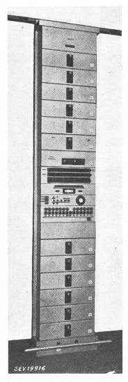
Fig. 4 Vollständiges 12-Kanal-System Hasler
