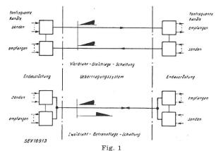
Trägersysteme in Vierdraht-Gleichlage- und Zweidraht-Getrenntlage-Schaltung
