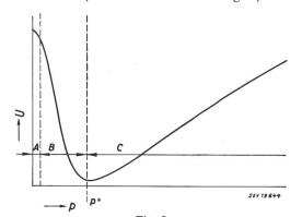
Fig. 2 Überschlagspannung zwischen parallelen Elektroden in Funktion des Druckes p Erklärungen siehe im Text
