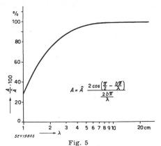
Relative Anzeige A/ in Funktion der Wellenlänge λ (cm) der als sinusförmig angenommenen Querschnittsveränderungen des Prüfgutes mit der Amplitude bei einer Breite b der Elektroden von 8 mm
