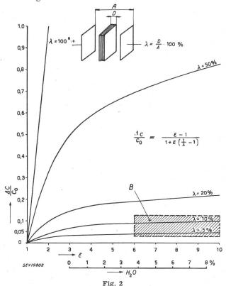
Relative Kapazitätsänderung  $\Delta C/C_0$  des Kondensatorelementes in Abhängigkeit von der Dielektrizitäts-Konstante  $\epsilon$  des Prüfgutes
