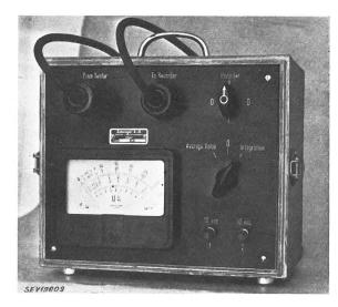
Fig. 9 Integrator zur Bestimmung der mittleren Ungleichmässigkeit eines Querschnittverlaufes
