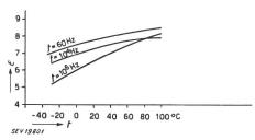
Fig. 1 Abhängigkeit der Dielektrizitäts-Konstante ε von Cellulose-Fasern von der Messfrequenz f und von der Temperatur t Messungen von Stoops
