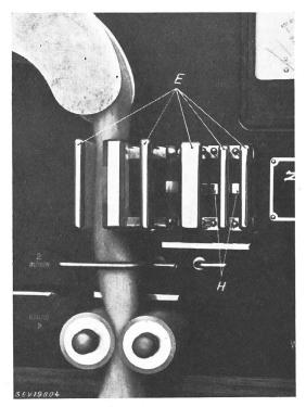
Fig. 4 Aufbau des Messkammes neue-Ausführung Erdplatten «Heisse» Elektroden
