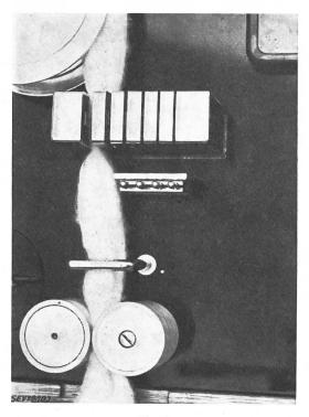
Fig. 3 Aufbau des Messkammes ältere Ausführung
