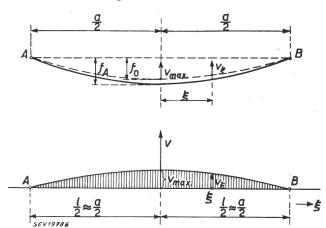
Angenommene Verteilung der vertikalen Seilgeschwindigkeit im Augenblick da das Seil die Schwelle des spannungsfreien Gebietes durchläuft
