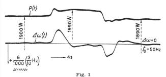
Réactions du régulateur en fréquence  $\Delta \omega$  (t) à des variations de puissance de la clientèle P(t) en réglage «isodrome» du groupe isolé
