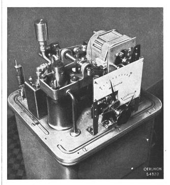
Fig. 3 Elektrohydraulischer Leistungsregler Verschalung teilweise entfernt
