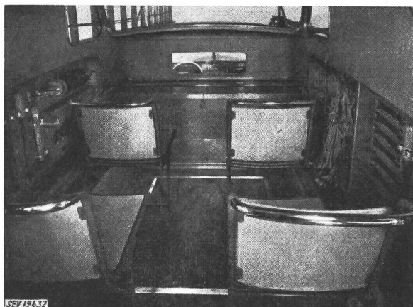
Fig. 4 Kastenraum des Hilfsfahrzeuges mit 4 Sitzen in abgeklappter Stellung
