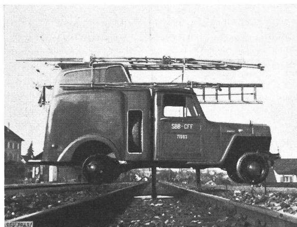
Fig. 3 Hilfsfahrzeug mit Schienenrädern in Wendestellung
