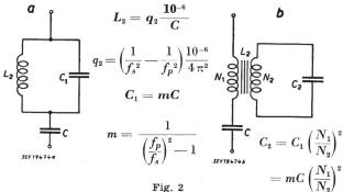
Fig. 2  $= mC \left(\frac{1}{N_2}\right)$ L<sub>2</sub> Induktivität der Drosselspule (Fig. 2a), bzw. Primärinduktivität des Transformators (Fig. 2b) in H
