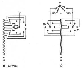
Fig. 1 Prinzipielle Schaltung von Lastregulierschaltern für zehn Stufen
