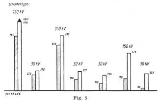
Stoßspannungsfestigkeit von Einbauregulierschaltern nach Prüfergebnissen
