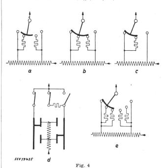
Gebräuchliche Überschaltsysteme für Schnellastschalter Darstellung in charakteristischen Überschaltstellungen a Fahnenschaltung; b Wimpelschaltung symmetrisch; c einseitige Wimpelschaltung; d einseitige Wimpelschaltung mit Doppelwähler; e kombinierte Fahnen-Wimpelschaltung
