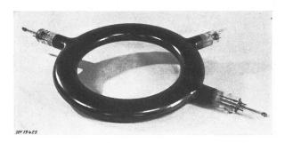
Fig. 1 Kreisröhre mit zwei Elektronenspritzen und einem Stutzen für das Zirkongetter
