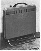
Heizofen gemäss Abbildung. Zwei Heizelemente mit Keramikisolation horizontal im unteren Teil eines Blechgehäuses eingebaut. Dreistufiger Regulierschalter vorhanden. Handgriff aus Isolierpreßstoff. Versenkter Apparatestecker für den Anschluss der Zuleitung.
