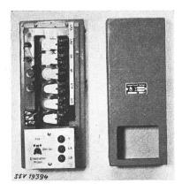
fährdeten Raumes befindet. Zwei Stromschleifen führen in den zu schützenden Raum und lösen bei Unterbruch durch die Feuermelder Signale oder die Betätigung von Löscheinrichtungen aus. Prüfung der Explosionssicherheit: Der bei Unterbrechung der Alarmschleifen entstehende Öffnungsfunke vermag nicht ein explosives Gasgemisch zu zünden.
