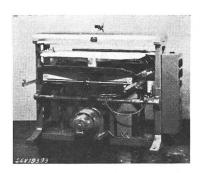
vorrichtung für die Bügeltische durch Schleifringankermotor mit Regulierwiderständen im Rotorstromkreis betätigt. Zur Steuerung sind Schaltschütze, Umschalter, Temperaturregler, Zeitrelais und Druckknopfschalter vorhanden. Steuerspannung 220 V. Reihenklemmen für den Anschluss der Zuleitungen. Erdungsklemme vorhanden.
