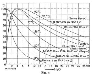
Tiefendosiskurven der Röntgenintensität in Wasser für verschiedene Elektronenenergien
