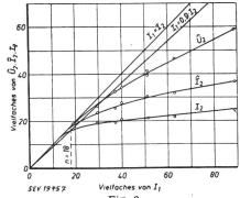
Fig. 2 Überstromkennlinien bei einer Bürde ohne Eisen Z= 1,2  $\Omega,\cos\beta=$  0,8, f= 50 Hz
