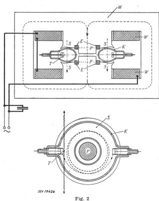
Prinzipschema des Strahlentransformators
