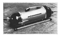
Mundstücken zum Saugen und Blasen verwendbar. Einpoliger Kipphebelschalter und Apparatestecker eingebaut. Zuleitung Gummiaderschnur mit 2 P-Stecker und Apparatesteckdose.
