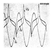
Fig. 1 Oszillogramm von  $I_1$ ,  $I_2$  und U2 im Überstromgebiet Bürde ohne Eisen  $I_1 = 88-7$ fach
