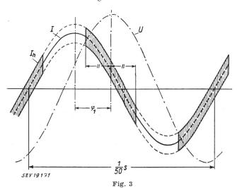
Schweißstrom mit überlagertem hochfrequentem Hilfsstrom U Netzspannung; I Schweißstrom; In hochfrequenter Hilfsstrom
