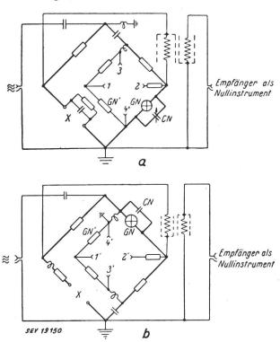
Fig. 5 Brückenmessung von Scheinwiderständen mit gesteuertem Widerstandsnormal
