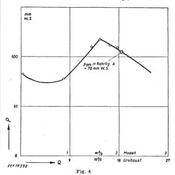
Kennlinie des radial durchströmten Hauptventilators bei geschlossenem Luftweg B Erläuterung s. Fig. 3
