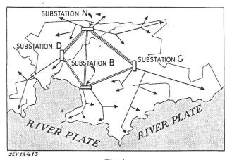
Fig. 4 Schema des 31.5-kV-Leitungsvierecks für die Versorgung von Montevideo
