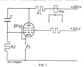
Schaltung für Schaltzeiten bis zu 12 min  $R_1=50~\mathrm{k\Omega};~R_2=2~\mathrm{M\Omega};~C=4~\mu\mathrm{F}$  Die Wirkungsweise der Schaltung beruht auf dem Entladeprinzip
