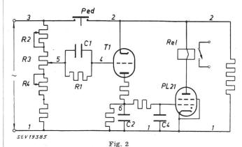
Zeitschalter für eine kleine Tischschweissmaschine, der nach dem Ladeprinzip arbeitet C<sub>1</sub> ist durch den gleichgerichteten Gitterstrom aufgeladen
