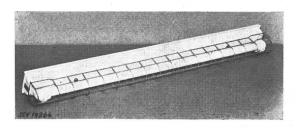
gen sind verlötet. Das Vorschaltgerät ist in einem Blechkasten untergebracht und vergossen. Die Armatur entspricht der Bauart «erhöhte Sicherheit» gemäss VDE 0170. Verwendung: in explosionsgefährlichen Räumen.
