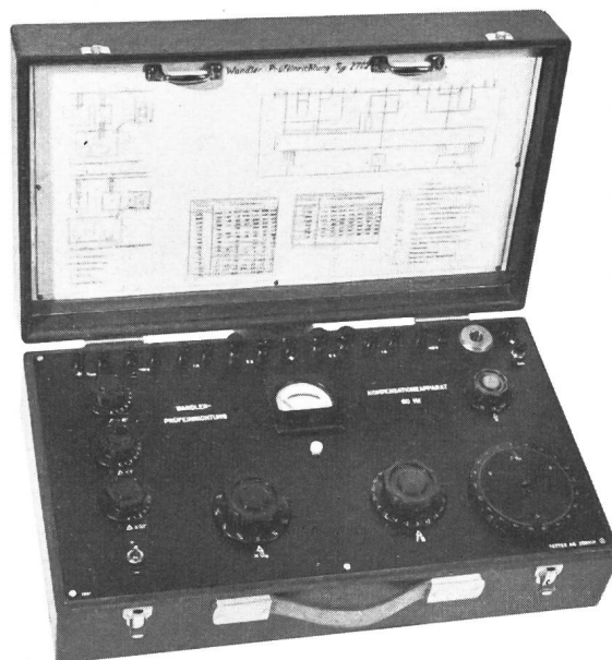
Fig. 1 Strom- und Spannungswandler-Prüfeinrichtung Kompensationsapparat, Typ 2701
