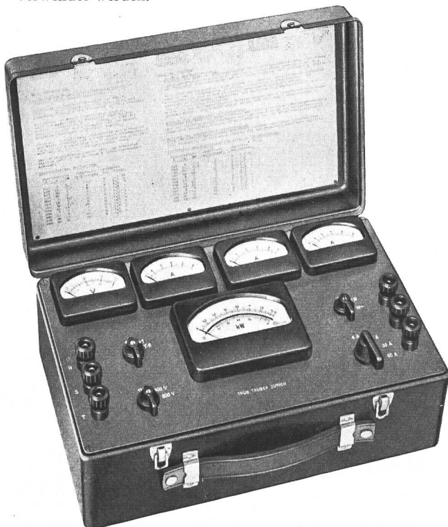
Fig. 3 Tragbarer Messkoffer für Strom-, Spannungs- und Leistungsmessungen
