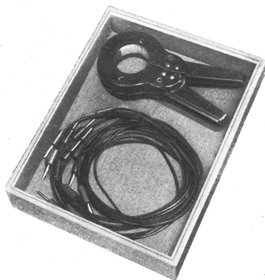
Fig. 3 Blindboden des Vancos-Meters für Zangenwandler und Anschlusskabel
