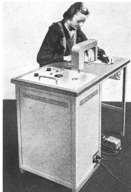
Fig. 1 Plastic-Näh-Schweissmaschine (HF-Generator für dielektrische Heizung)
