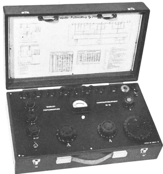
Fig. 1 Strom- und Spannungswandler-Prüfeinrichtung Kompensationsapparat, Typ 2701
