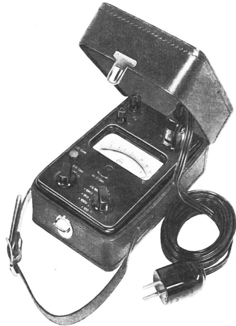
Fig. 5 Universal-Isolations- und Widerstand-Messgerät Ohmi
