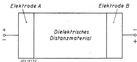
Fig. 1 Schematischer Querschnitt durch einen gewöhnlichen Kondensator
