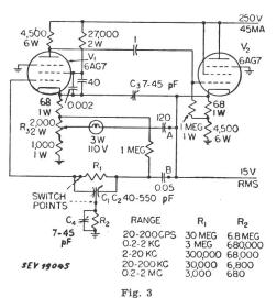
Vollständiges Schema des Breitband-Oszillators
