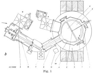
Stark vereinfachter vertikaler und horizontaler Querschnitt des Philips Synchrozyklotrons in Amsterdam
