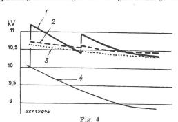
Änderung der Spannung in Funktion der Entfernung von der Speisestation bei Anwendung von Seriekondensatoren
