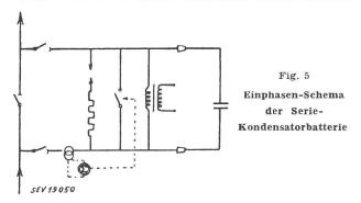
übersteigt, wird diese Batterie durch einen automatisch gesteuerten Schalter kurzgeschlossen. Er öffnet sich automatisch, wenn der Strom seinen Normalwert erreicht hat. Die Batterie selbst besteht aus Einheiten von 20 kVar für eine Spannung von 1500 V (9 pro Pol) französischer Konstruktion. Die Isolationsspannung der in Öl imprägnierten Kondensatoren beträgt 10 kV. Es wurden vorläufig 6 Einheiten pro Pol eingeschaltet, was bei einem Polleiterstrom von
