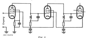
Der Reihenverstärker als Bandpass-ZF-Verstärker für Rundfunkempfänger
