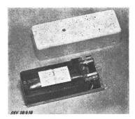
Kupferdraht. Störschutzkondensator von 0,04  $\mu F$  parallel zur Lampe angeschlossen. Klemmen auf Isolierpreßstoff montiert. Grundplatte und Deckel aus Aluminiumblech.
