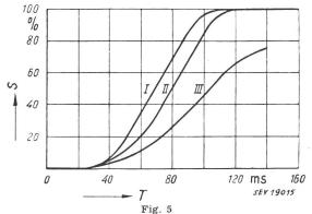
Echostörungen S mit der Echoklangfarbe als Parameter I normal; II Bass gedämpft; III Diskant gedämpft
