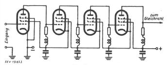
Fig. 1 Prinzipschaltung eines Reihenverstärkers als ZF-Breitbandverstärker
