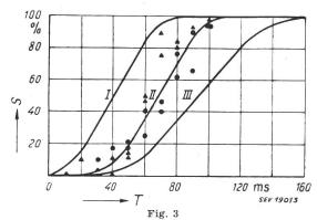
Echostörungen S mit der Sprechgeschwindigkeit als Parameter I 7,4 Silben/s; II 5,3 Silben/s; III 3,5 Silben/s
