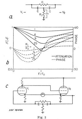
Schema (a) und Charakteristik (b) des T-Gliedes und das vereinfachte Schaltschema (c) des RC-Oszillators
