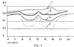
Spannungsschwankungen während eines Tages unter Annahme einer vollregulierten 30-kV-Spannung
