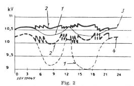
Spannungsschwankungen während eines Tages mit oder ohne parallelgeschalteter Kondensatorbatterie
