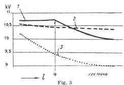
Änderung der Spannung in Funktion der Entfernung von der Speisestation bei Anwendung von Parallelkondensatoren
