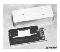
von 10 000 pF parallel zur Lampe angeschlossen. Grundplatte und Deckel aus Aluminiumblech. Klemmen auf Isolierpressstoff montiert. Das Vorschaltgerät hat die Prüfung in Anlehnung an die «Kleintransformatoren-Vorschriften» (Publ. Nr. 149) bestanden. Verwendung: in trockenen und zeitweilig feuchten Räumen.
