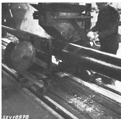
Fig. 2 Isolation d'une conduite d'eau (Zwahlen & Mayr, Lausanne)
