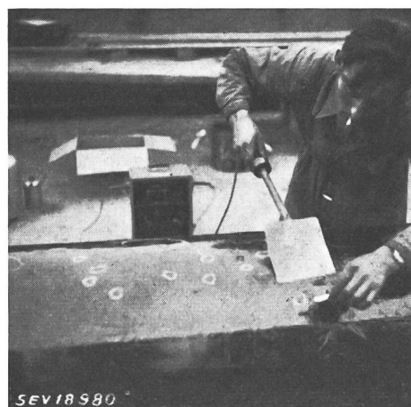
Fig. 4 Contrôle électrique à haute tension d'une isolation «Vetro-Waberit» Les endroits poreux décelés par l'arc sont marqués à la craie puis refondus au chalumeau (Strassenbaumaterial A.-G., Berne)
