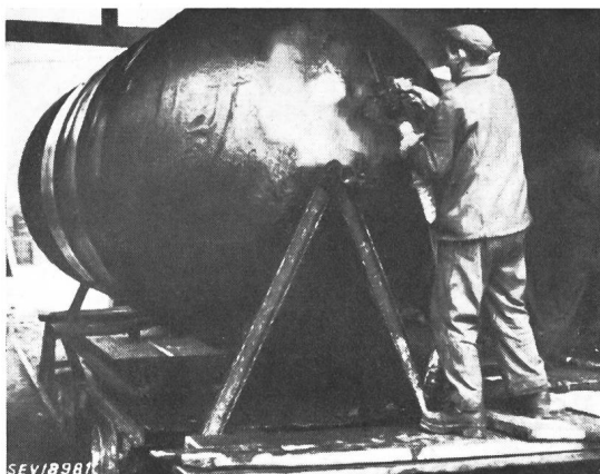
Fig. 5 Isolation «Veroid» d'une citerne (Meynadier & Cie, Zurich)
