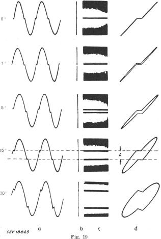
Oszillogramme zur Phasenmessung mit einer «geknickten» sinusförmigen Wechselspannung Erklärungen siehe im Text
