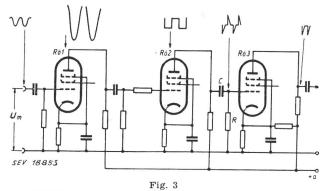
Grundsätzliches Schaltbild zur Erzeugung von Impulsen aus einer sinusförmigen Wechselspannung für Phasenmessungen mit Oszillographen
