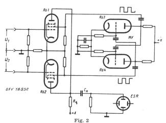
Grundsätzliches Schaltbild eines «Elektronischen Schalters»  $R\ddot{o}1...R\ddot{o}4$  Elektronenröhren;  $U_1$ ,  $U_2$  Meßspannungen; MV Multivibrator;  $R_a$  Anodenwiderstand; ESR Elektronenstrahlröhre
