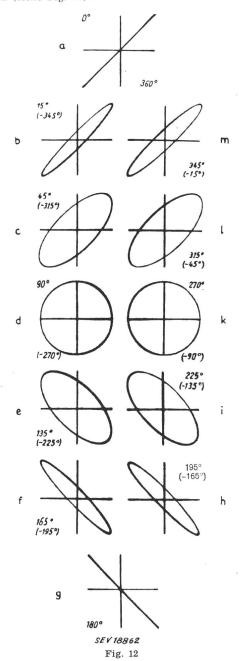
Oszillogramme zur Phasenmessung mit Hellsteuerung zur eindeutigen Kennzeichnung für alle Bilder zwischen  $0^\circ$  und  $360^\circ$
