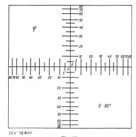
Fig. 11 Skala zur Phasenmessung für  $\varphi < 90^\circ$
