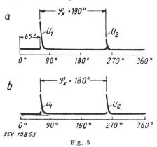
Oszillogramme zum Phasenvergleich mit Impulsen
