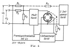
Schaltbild zum Phasenvergleich mit Impulsen nach Schaltung in Fig. 3
