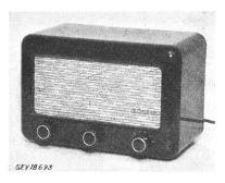
Lautsprechers möglich. Netztransformator mit getrennten Wicklungen. Schutz gegen Überlastung durch zwei Kleinsicherungen vor den Anoden der Gleichrichterröhre. Primärseite des Eingangsübertragers mit dem Chassis verbunden. Gehäuse aus Isolierpreßstoff mit Preßspanrückwand. Zuleitung Rundschnur mit Stecker, fest angeschlossen. Je zwei 6-mm-Büchsen für den Telephonanschluss und für einen zweiten Lautsprecher.
