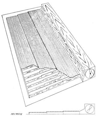
Fig. 2 Seitlich angeordneter Hauptkanal mit Lattenboden
