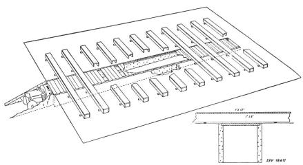
Fig. 1 Unterirdischer Hauptkanal mit seitlichen Luftgängen
