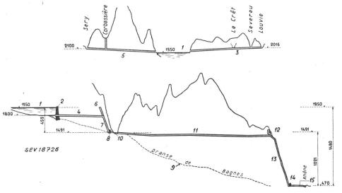
Maschinenhaus Ecône, zwischen Riddes und Saxon, ausgerüstet vorläufig mit 3, später mit 5 Gruppen, angetrieben durch je 2 horizontalachsige Peltonturbinen
