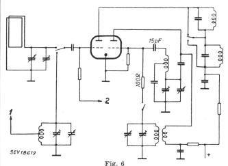
Amerikanische Mischstufe für UKW- und Mittelwellenempfang mit Doppeltriode als Mischrohr 1 zur FM-Antenne; 2 zum Regelkreis
