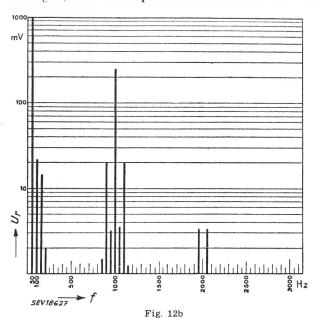
Kreuzmodulation an einem als Ausgangstransformator verwendeten Netztransformator  $U_r$  relative Ausgangsspannung; f Frequenz
