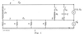
Schema der Messanordnung 1 Transformator; 2 Polleiter; 3 Nulleiter; 4 Erd-Übergangs-Widerstände; 5 Erde;  $R_1$  Belastungswiderstand; C Kondensator; U Spannung bei geöffneten Schaltern;  $U_1$  Spannung bei Belastung durch  $R_1$  ( $S_1$  geschlossen);  $U_2$  Spannung bei Belastung durch C ( $S_2$  geschlossen);  $U_1$  Berührungsspannung bei geschlossenem Schalter  $S_1$ ;  $Z_p$ ,  $Z_0$ ,  $Z_T$  Impedanzen
