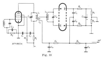
Typische Schaltung eines symmetrischen Verhältnisgleichrichters (Ratiodetektor)
