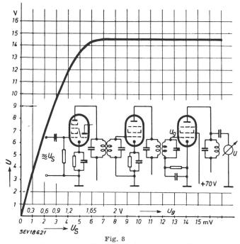
Die Röhre EF 12 als Pentodenbegrenzer mit gleitender Schirmgitterspannung
