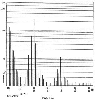
Kreuzmodulation an einem üblichen kleinen Ausgangstransformator Signalgemisch 1000 Hz + 50 Hz  $U_r$  relative Ausgangsspannung; f Frequenz
