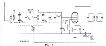
Additive Mischung und Schwingungserzeugung in einer Röhre
