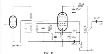
FM-Demodulation mittels einer Röhre EQ 80
