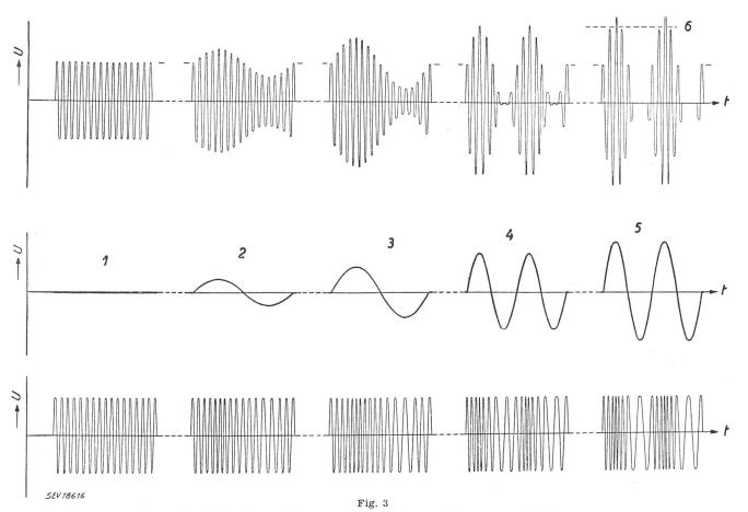
Vergleichende Darstellung von Amplituden- und Frequenzmodulation Mitte: niederfrequentes Signal; 1 Ruhe; 2 leiser Tiefton; 3 lauter Tiefton; 4 sehr lauter Hochton; 5 überlauter Hochton Oben: amplitudenmodulierter Träger; 6 Übermodulation Unten: frequenzmodulierter Träger U Spannung; t Zeit
