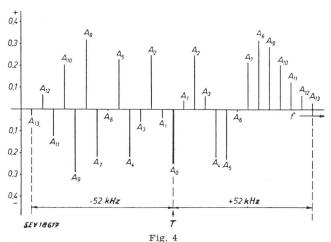
Frequenzspektrum einer mit 4000 Hz bei einem Hub von  $\pm$  40 kHz frequenzmodulierten Welle  $A_0...A_{13}$  Seitenbänder; T Trägerwelle; f Frequenz
