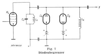
1 Ausgang der begrenzten Zwischenfrequenzspannung
