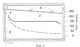
Schematischer Querschnitt des Schulzimmers Fig. 1 mit Lichtverteilungskurven
