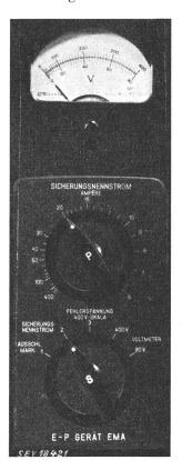
abgetrennten Kasten B an den Anschlussbüchsen E...F (Fig. 6 und 8) an beliebigen Stellen im Bereiche der Fehlerstrombahn die Fehlerspannungen bestimmt werden. Der Prüfbeamte benötigt hier ausnahmsweise eine Hilfsperson, die z. B. zu abgemachter Zeit am Kasten A auf die Taste T drückt, währenddem er am Kasten B im Instrument Vdie Zeigerausschläge beobachtet.
