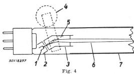
Elektronenpistole mit Kröpfung. Die Ionen fallen hier auf die Metallwandung der Anode
