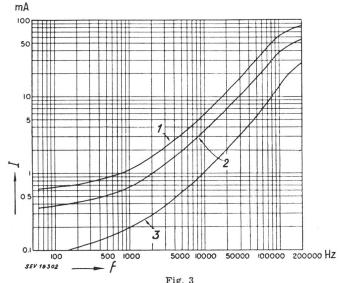
Wie Fig. 1, aber wenn ein Mittelfinger 1...2mal pro s leicht auf einer Kupferplatte aufschlägt Bezeichnungen wie bei Fig. 1
