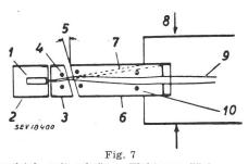
Elektronenpistole mit schrägen Elektronenflächen, nach dem Prinzip des unabgelenkten Strahls, wie sie in der Röhre 10 BP 4 benützt wird
