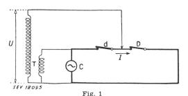
Prinzipschema der synthetischen Prüfversuche C Generator; T Transformator; D der zu prüfende Schalter; d Hilfsschalter; U Spannung; I Strom
