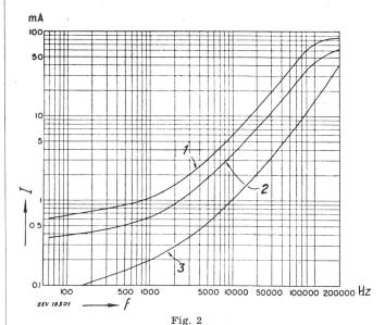
Wie Fig. 1, aber bei leichter Berührung einer Kupferplatte durch einen Mittelfinger Bezeichnungen wie bei Fig. 1
