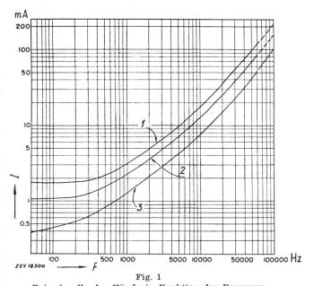
Reizschwelle der Hände in Funktion der Frequenz (Cu-Draht von 3,3 mm Querschnitt in der Hand gehalten) 1 99,5 % aller Versuchspersonen; 2 50 % aller Versuchspersonen; 3 0,5 % aller Versuchspersonen; f Frequenz; I Stromstärke
