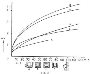
Vergleich der verschiedenen Arten von Wasseraufnahmen an einem Probekörper
