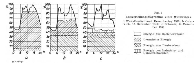
Fig. 1 und 2 zeigen charakteristische Lastverteilungsdiagramme an je einem Winter- und Sommertag in 3 verschieden gearteten Verbundsystemen: Westdeutschland mit einem Überwiegen der thermischen Erzeugung im Sommer und
