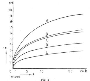
Wasseraufnahme durch Kapillarität an Probekörpern aus verschiedenen Masten  $A,\ B,\ C,\ D$  und an einem Betonmuster L
