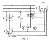
Schaltung zur Untersuchung der Strom- und Spannungsverhältnisse
