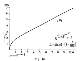
Abhängigkeit der durch den Fehlwinkel  $\delta$  entstehenden Wirkstromkomponente  $I_u$ ' vom Erdschlußstrom I
