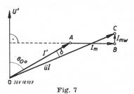
Vektordiagramm des Kabelringwandlers bei vorwiegend induktiver Belastung
