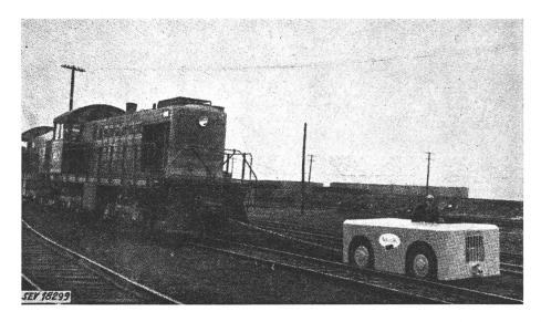
Fig. 1 Industrie-Traktor, einen Güterzug schleppend
