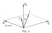
Kompensierungsdiagramm  $U_0$  Nullpunktspannung;  $I_B$  Erdschlußstrom des Netzes;  $I_S$  Löschstrom der Spule; I Erdschlußreststrom; I' Sekundärstrom im Relais;  $\delta$  Phasenverschiebung
