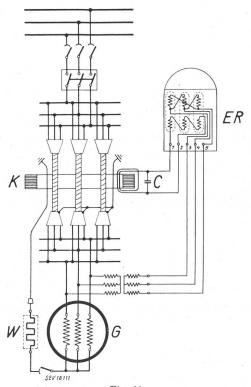
Fig. 11 Schaltung eines empfindlichen Generator-Gehäuseschluss-Schutzes
