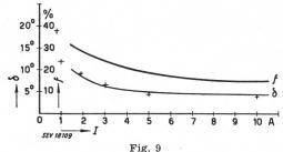
Fehlwinkel  $\delta$  und Übersetzungsfehler f eines Kabelringwandlers in Abhängigkeit vom Erdschlußstrom I
