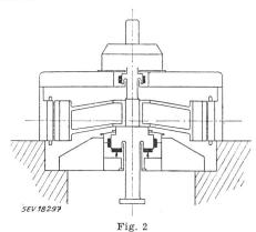
Gleiche Disposition der Führungslager wie in Fig. 1 mit dem Spurlager unterhalb des Rotors
