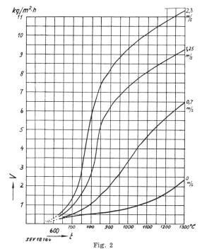
Der Abbrand von Elektrodengraphit in Funktion der Luftgeschwindigkeit an der Elektrodenoberfläche V Abbrand; t Temperatur
