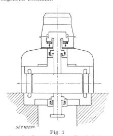
Disposition der Lagerung eines Vertikal-Generators Je ein Führungslager ist über und unter dem Rotor und das Spurlager über dem Rotor angeordnet
