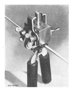
Fig. 2 Schweisszange mit 2 prismatischen Aluminium-Backen Versuchsausführung
