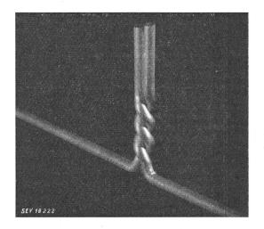
Fig. 1 Abgebogene und parallel gerichtete Rein-Aluminium-Drähte (28 mm² Querschnitt), bereit zum Ansetzen der Zange
