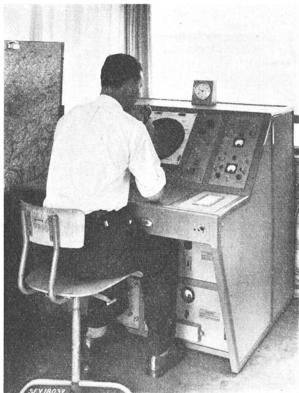
Fig. 15 Fernanzeigegerät im Kontrollturm
