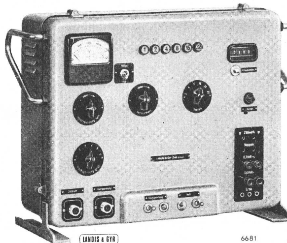
Fig. 3 Elektronischer Impulsuntersetzer zur Feststellung der Ansprechzahl von Geiger-Müllerschen Zählrohren
