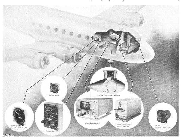
Fig. 7 Automatischer Radiokompass
