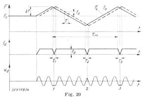
Arbeitsprinzip eines Radarhöhenmessers mit Frequenzmodulation
