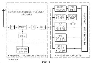
280-Kanalempfänger für Omni-Range, Communication und ILS-Localiser im Blockschema
