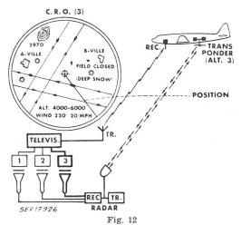
Teleran-System, eine Kombination von Radar mit Fernsehen
