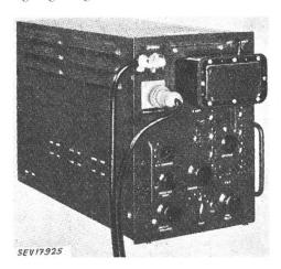
Fig. 11 Loran-Bordempfänger
