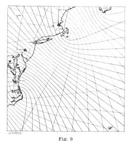
Hyperbelscharen des Loran-Langstrecken-Navigationssystems
