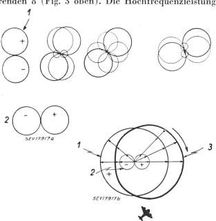
Fig. 3 Entstehen der Cardioid-Antennencharakteristik einer Omni-Range-Bodenstation
