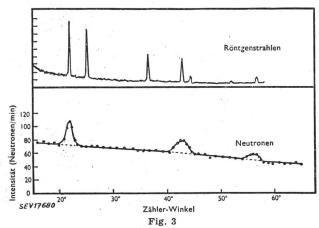
Gegenüberstellung der Pulverdiagramme von Röntgen- und Neutronenstrahlen an Natriumhydrid
