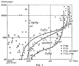
Änderung der Übergangswiderstände verschiedener Kontaktwerkstoffe in Abhängigkeit von der Schaltzahl Ag Silber Cu Kupfer
