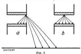
Wiedergewinnung von Schaltelement-Silber a Kontaktgebung in der Randzone b Kontaktgebung in der Mitte des Schaltelementes
