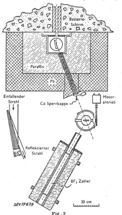
Neutronenbeugung mit der Pulvermethode Ein monochromatischer Neutronenstrahl wird durch Braggsche Reflexion an einem Einkristall erhalten
