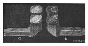
Abbrandversuch mit Silber- und Kupferschaltelementen
