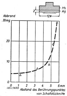
Fig. 5 Abbrand in Funktion des Schaltelement-Durchmessers
