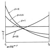
Fig. 3 Allure du gradient de dans l'isolant tension d'un câble pour différents modes de charge Courbes pour  $0 \le p < 1$ : gradient de tension continue à vide ou de tension alternative à vide et en charge
