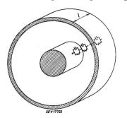
Fig. 2 Circuit équivalent à une longueur unité de câble longueur unité
