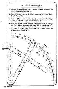
Fig. 5 Rechenhilfsmittel zur Ermittlung des  $\cos q$  und des  $\sin q$
