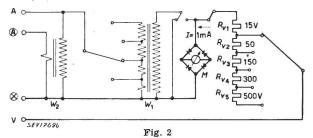
Spannungsmessung mit umschaltbaren Vorwiderständen
