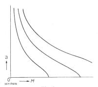
Fig. 1 Mechanische Charakteristiken des Einphasen-Seriemotors bei drei verschiedenen Werten des Parameters der Spannungs-Stufung
