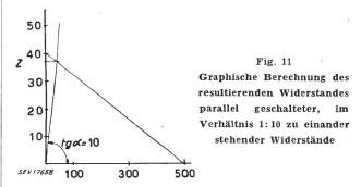
trägt. Sollen z. B. die Widerstände  $40~\Omega$  und  $500~\Omega$ parallel geschaltet werden, so erhalten wir nach Fig. 11
