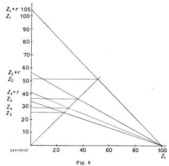
Graphische Ermittlung des resultierenden Widerstandes parallel geschalteter gleicher Widerstände, die in gleichmässigen Abständen in einer Leitung liegen
