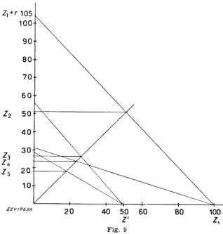
Graphische Ermittlung des resultierenden Widerstandes parallel geschalteter ungleicher Widerstande, die in gleichmässigen Abständen in einer Leitung liegen
