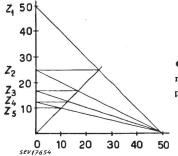
Fig. 7 Graphische Ermittlung des resultierenden Widerstandes parallel geschalteter gleicher Widerstände
