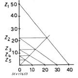
Fig. 6 Graphische Ermittlung des resultierenden Widerstandes parallel geschalteter ungleicher Widerstände
