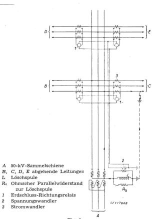
Fig. 1 Prinzipschema einer Erdschluss-Richtungsanzeige in einem Strahlen-Netz
