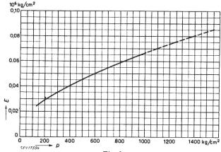
Fig. 1 Elastizitätsmodul E von Amberit in Funktion der spezifischen Pressung p nach einer Vorpressung mit 400 kg/cm² bei 160 °C
