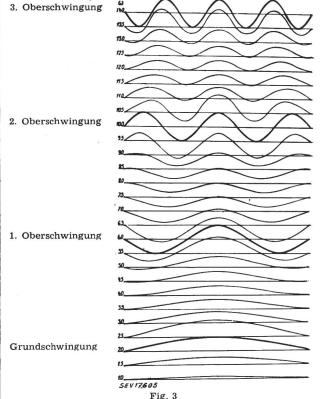
Ideelle Erregung eines Hohlseiles durch Windkräfte
