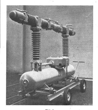
Fig. 1 Ein Pol des 150-kV-Druckluftschnellschalters nach dem Aufenthalt im Tiefkühlraum, bereit zur Prüfung auf Betriebsicherheit
