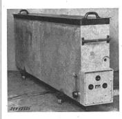
Fahrbarer Trog gemäss Abbildung, zum Ablaugen von Fensterläden. Eingebaute Heizung, bestehend aus drei horizontal eintauchenden Heizelementen mit Keramikisolation und Metallmantel. Drei Schalter für die Heizung und Anschlussklemmen in dichten Blechkasten eingebaut. Alle Handgriffe isoliert. Trog wärmeisoliert. Innenmasse:  $250 \times 820 \times 2500$  mm.
