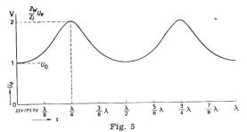
Fehlanpassung auf der Generatorseite bei offenem Ausgang Verlauf der Leerlaufspannung des Ersatzschemas  $U_e$  in Funktion der Kabellänge $Z_W = 2 \ Z_t$
