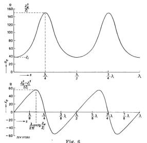
Fehlanpassung auf der Generatorseite bei offenem Ausgang  $Zw=75~\Omega;~Z\iota=37,5~\Omega$
