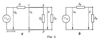
Schema eines über ein Coaxialkabel belasteten Messgenerators
