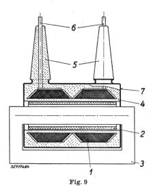
Prinzipskizze eines Kunstharz-Spannungswandlers, zweipolig, mit zwei lagengesteuerten Spulen
