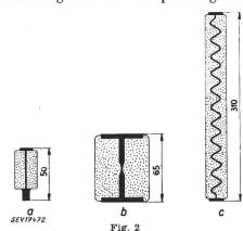
Anordnung der Schmelzleiter bei verschiedenen Sicherungssystemen a D-Sicherung; b NH-Sicherung; c HH-Sicherung
