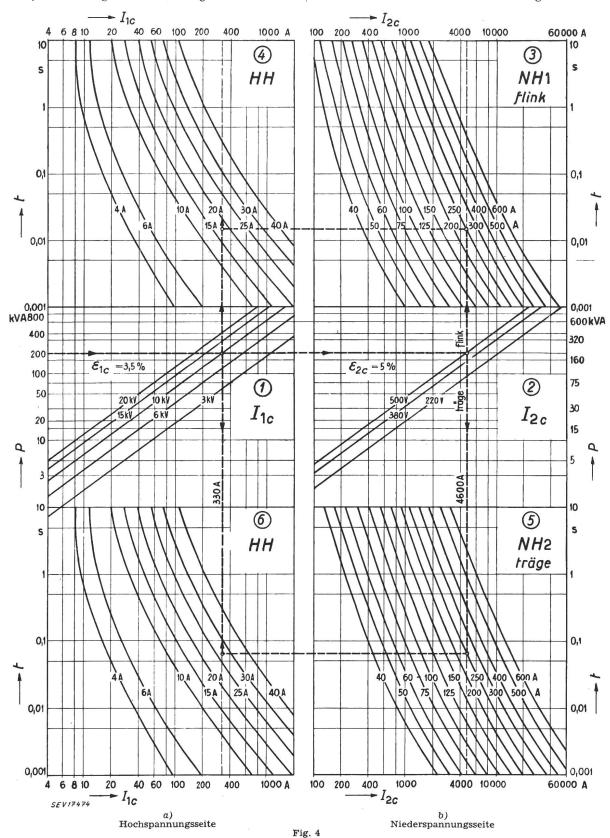
Bestimmung der Nennstromstärke von HH-Sicherungen für Selektivität mit HH-Sicherungen für Transformatoren
