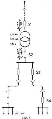
Schematische Darstellung einer Verteilanlage ab Ortstransformatoren-Station
