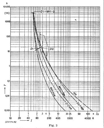
Vergleich von Abschmelzcharakteristiken verschiedener Sicherungssysteme für einen 40-A-Schmelzleiter I Überstrom;  $I_n$  Nennstrom; t Abschmelzzeit;  $D_1$  Vorschrift des SEV für  $D_1$ -Sicherungen;  $D_2$  Vorschrift des SEV für  $D_2$ -Sicherungen;  $D_1 + NH$  1—2 Vorschrift des SEV für  $D_1$ - und NH-1—2-Sicherungen
