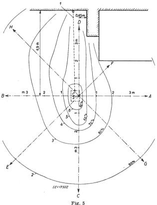
Niveaulinien konstanter Spannungsdifferenz um die Erdelektrode herum
