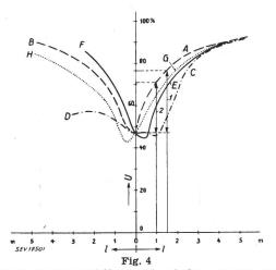
Prozentuale Spannungsdifferenz U zwischen der Einzelschutzerdung und der Erde mit Potential 0 als Funktion des Abstandes l vom Abszissennullpunkt 0
