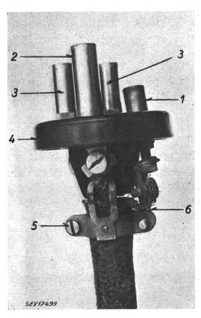
Fig. 2 Kupplungssteckdose, an welcher sich der ereignete (ohne Schutzdeckel) Isolationsfehler
