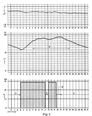
Verlauf der Innenraum- und Aussentemperatur am 28. Januar 1950 sowie das Belastungsdiagramm
