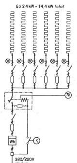
Die gesamte Länge der verlegten Heizkabel beträgt 740 m. Diese ist in 6 Teilstücke von je ungefähr 123 m unterteilt. Jedes dieser Teilstücke ist für eine Heizleistung von 2,4 kW dimensioniert.
